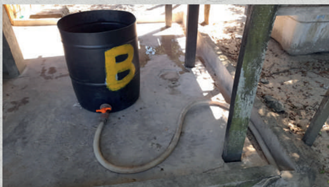
Figura 22. Exemplo de recipiente para maceração com dispositivo para escoamento da água. Fonte: Adriana Colosio.
