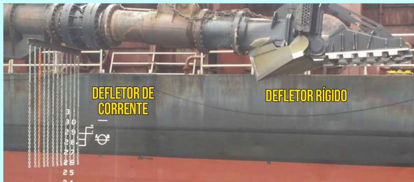
Figura 16: Exemplos de defletores flexível (de correntes) e rígido instalados em uma draga. Fonte: Porto do Açu (2021).
