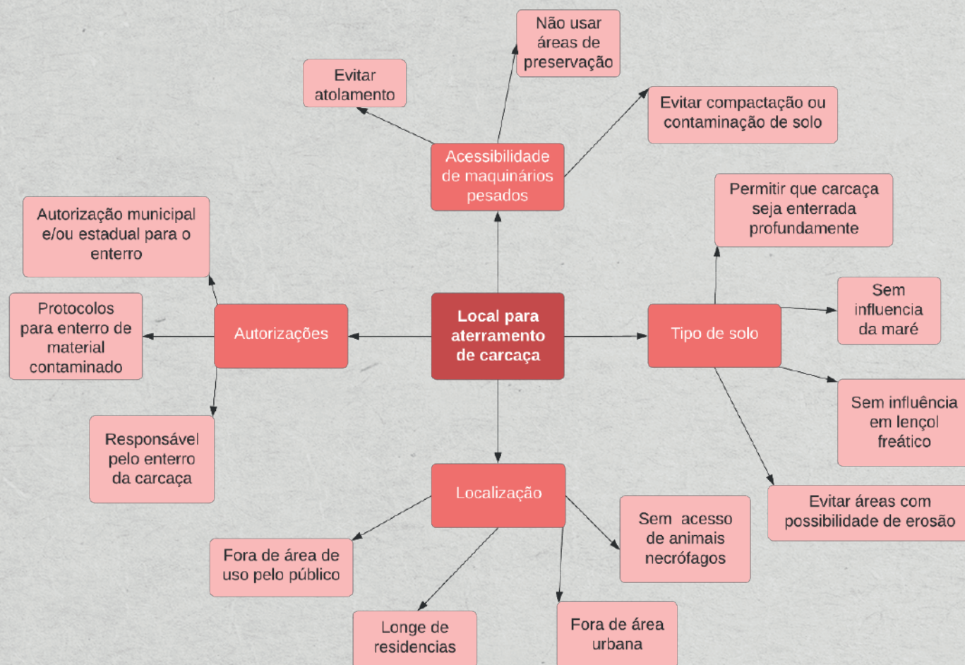
Figura 46. Esquema para escolha de local de destinação de carcaça, quando da ausência de aterro sanitário específico para a atividade.
