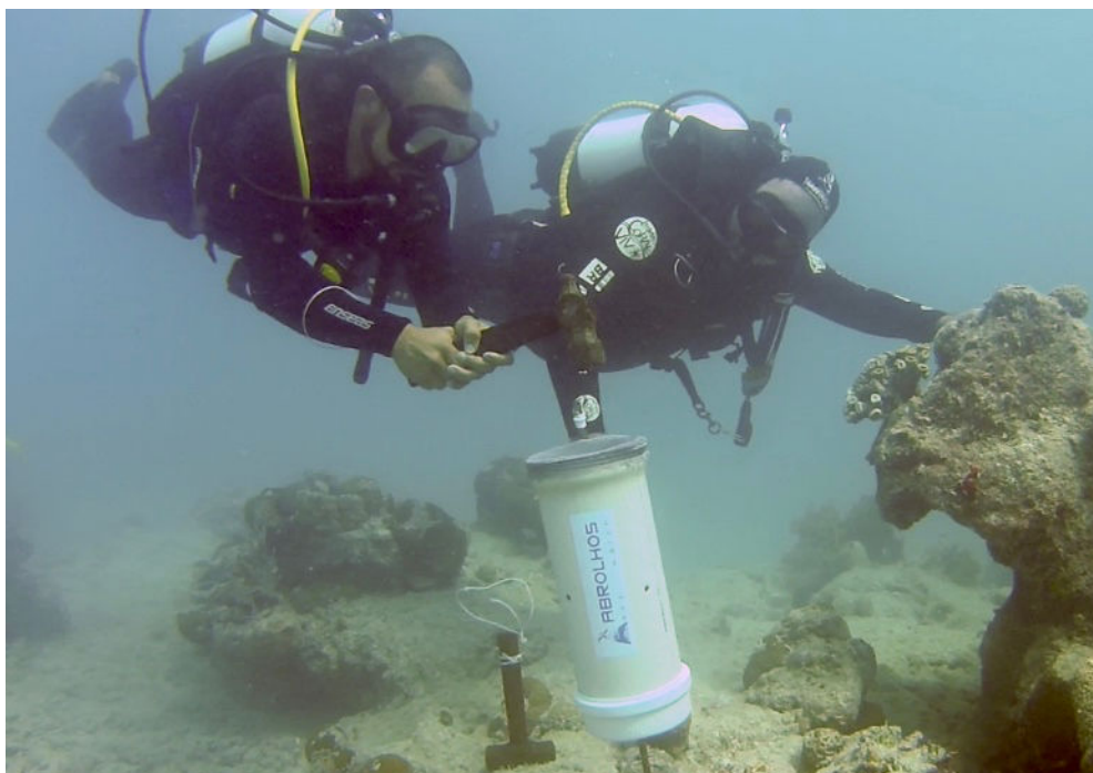
Figura 2. Montagem das armadilhas em Abrolhos para coleta de amostras de sedimentos para a execução do presente estudo.
