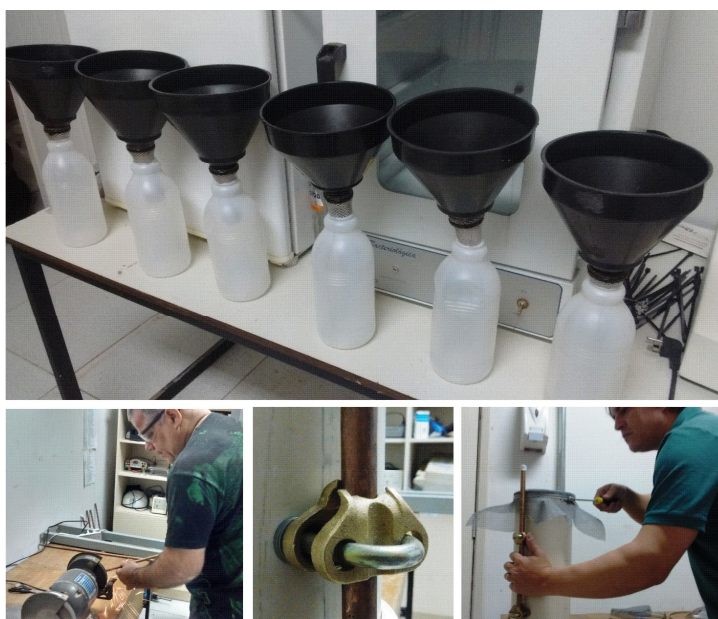
Figura 1. Montagem das armadilhas que foram instaladas em Abrolhos para coleta de amostras de sedimentos para a execução do presente estudo.
