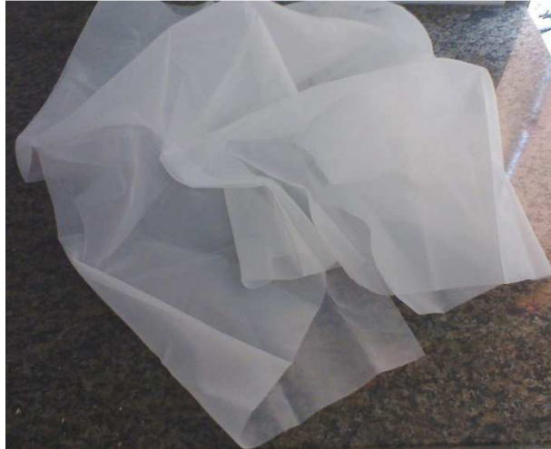
Figura 03: Malha de náilon 20 \mu m. A malha deverá ser utilizada como rede e passada a profundidade de 30 cm para coleta de fitoplâncton.
