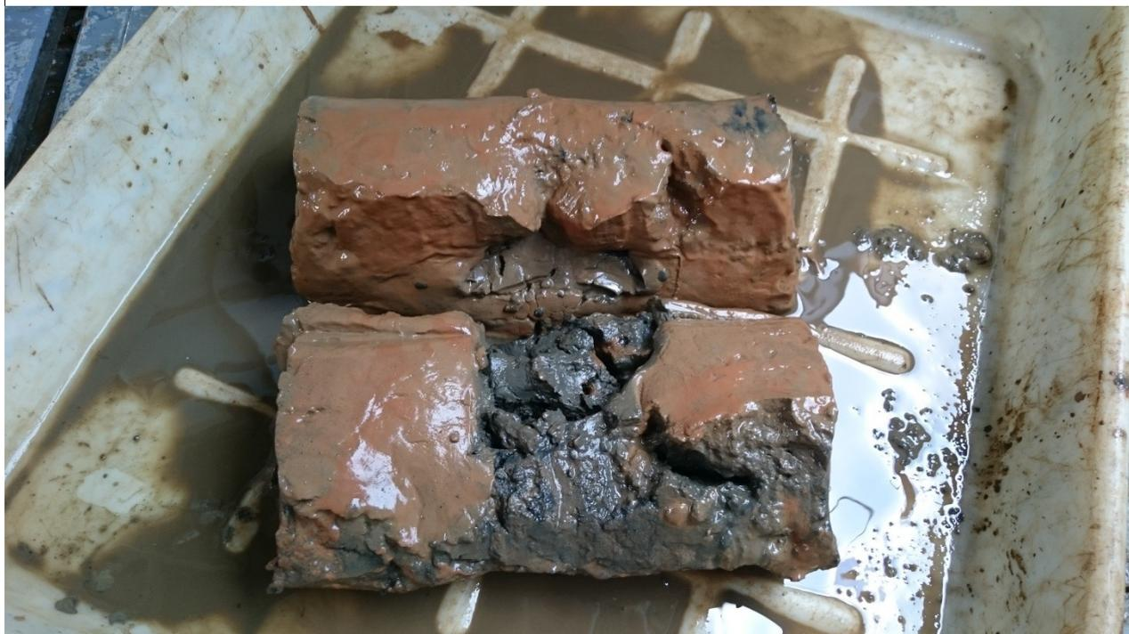
Figura 5b: Amostras de sedimento coletadas com draga tipo van veen.
