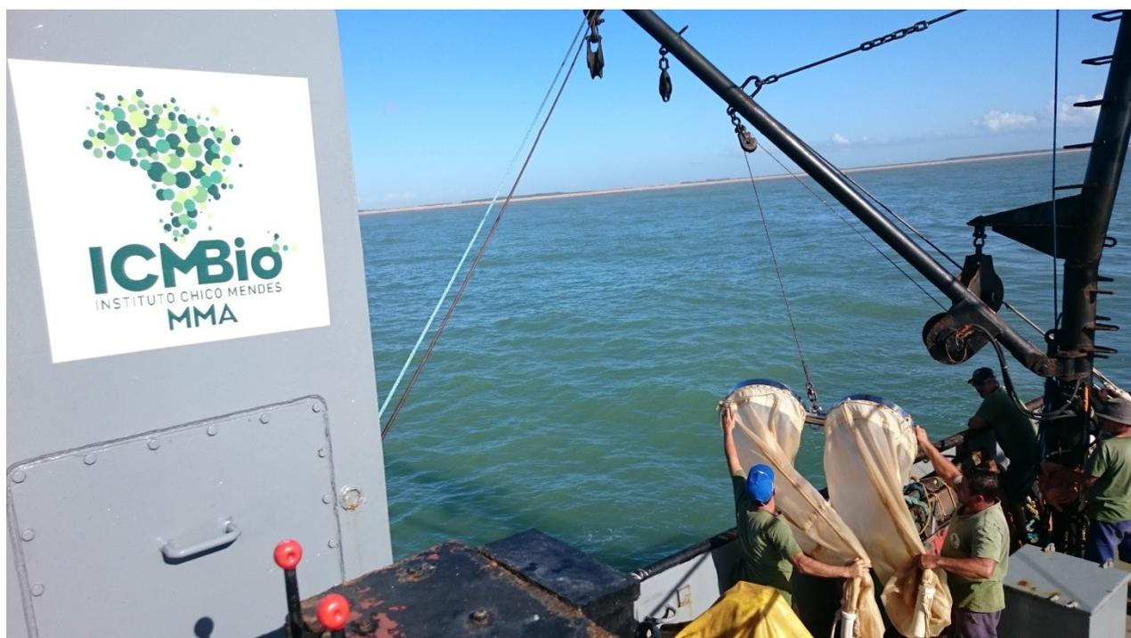
Figura 6: Coleta das larvas e ovos de peixes (ictioplâncton) utilizando-se rede do tipo bongô.
