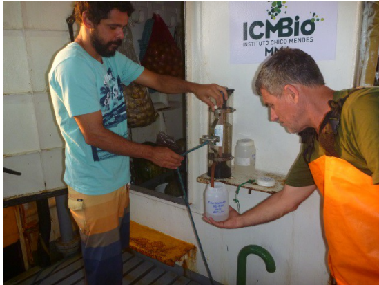
Figura 2: coleta de água com garrafa horizontal de Niskin.
