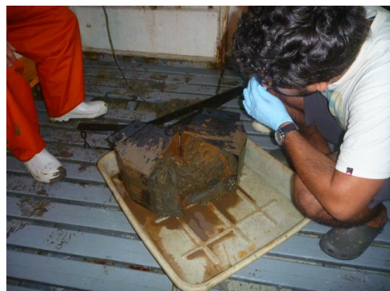
Figura 3: Amostras de sedimento coletadas com draga tipo van veen.
