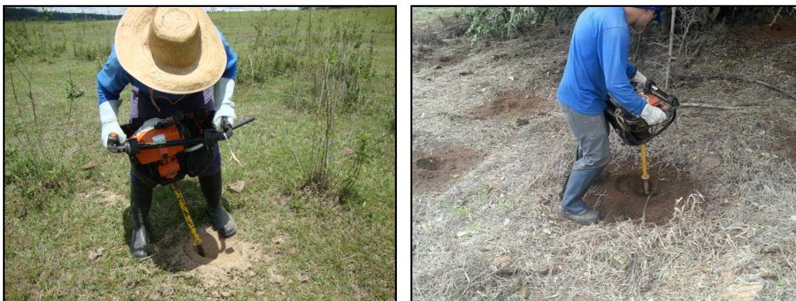
Figuras 14 e 15: Abertura de berços com motocoveadeira.
