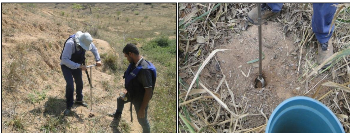
Figuras 1 e 2: Retirada da amostra com a profundidade desejada através de um trado.
