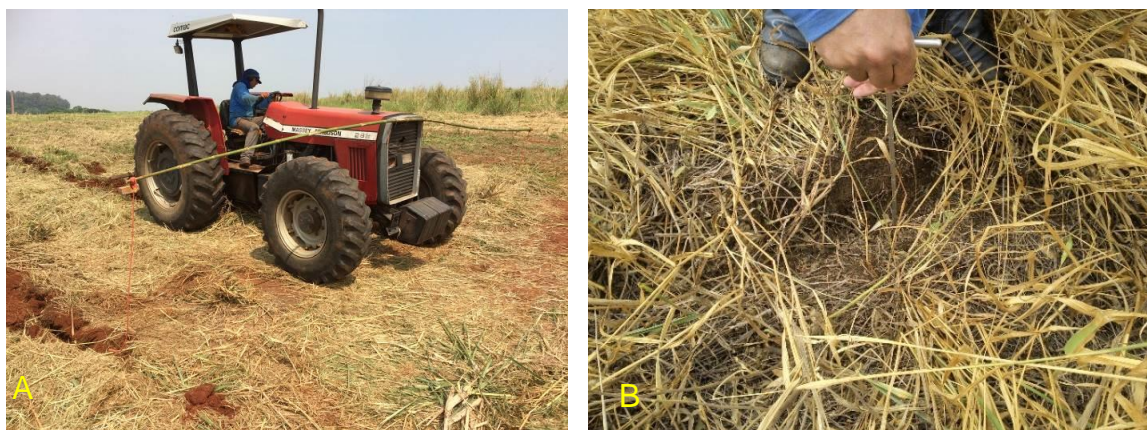
Figura 20. A) Uso de subsolador para a descompactação do solo. B) Restaurador conferindo a profundidade da porção do solo subsolada com uma haste de metal.
