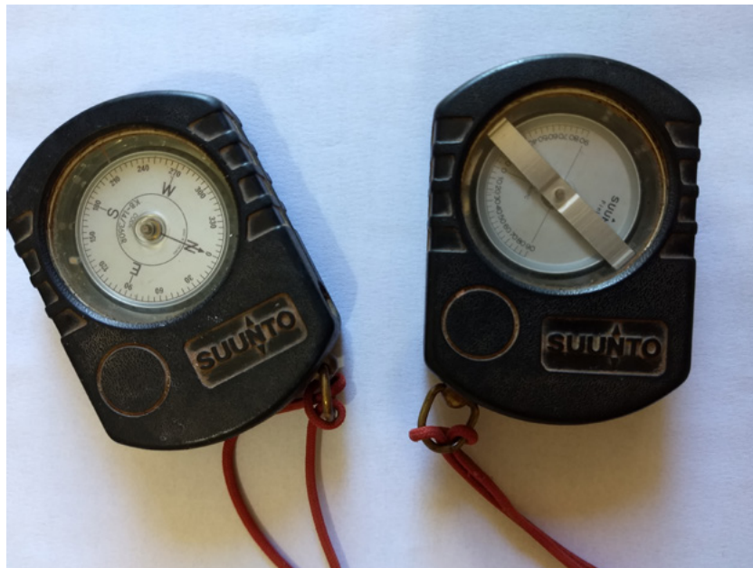
Figura 2 – Bússola (à esquerda) e clinômetro (à direita) utilizados no mapeamento espeleológico Fonte: Foto do autor
