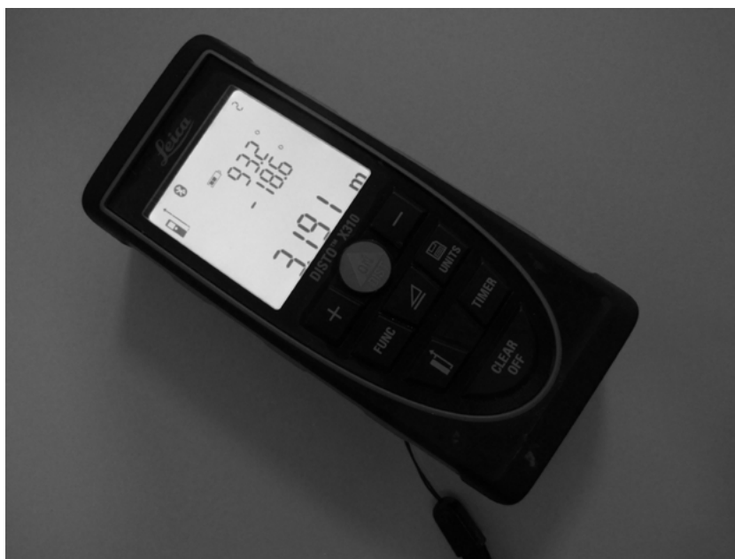
Figura 3 – Disto X. Equipamento montado na treina Leica Disto X310, que mede distâncias, azimute e inclinação
