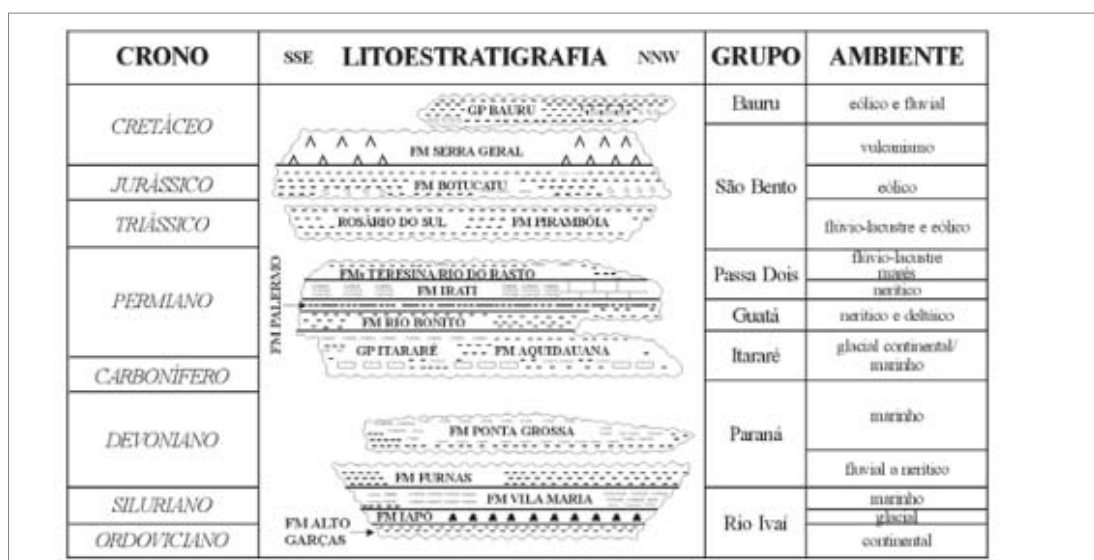
Figura 13. Coluna cronolitoestratigráfica da Bacia Sedimentar do Paraná, mostrando a distribuição espacial e temporal das principais litologias observadas, os grupos das principais formações geológicas e os ambientes formadores dessas litologias.
