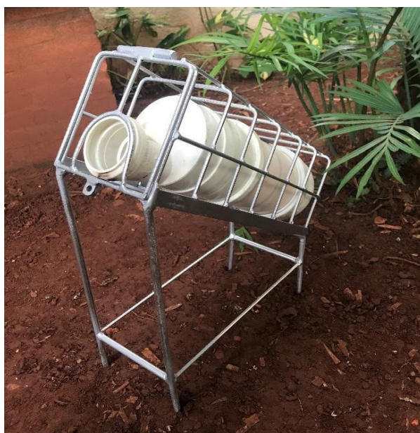
Fig. 16: Modelo do comedouro de PVC e suporte metálico utilizado para alimentação dos tamanduás-bandeira do Projeto TamanduASAS. O suporte é composto de metalon, com 34 cm de comprimento e 54 cm de altura, e o comedouro possui 30 cm de comprimento e utiliza cano PVC para esgoto 100 mm, conexão CAP para esgoto 100 mm e redução excêntrica para esgoto 100 mm x 50 mm.
