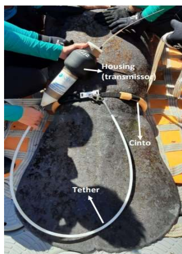
Figura VI.2.5-1 - Representação do equipamento de radiotelemetria utilizado no monitoramento pós-soltura de peixes-bois-marinhos, evidenciando cinto, cabo ( tether ) e boia ( housing ) contendo os transmissores: VHF e GPS.
