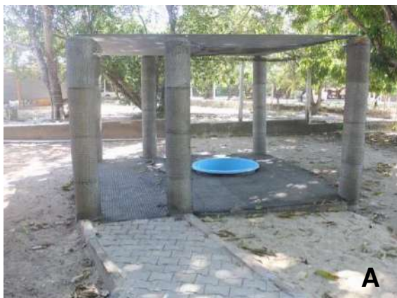
Figura III.3.4-4 – Recintos destinados a atendimento de fauna oleada. A) Recinto telado para aves, com antessala para evitar fuga de animais e piscina de baixa profundidade (alimentada com água doce ou salgada). B) Recinto (29,4m 2 ) isolado dedicado a estabilização e tratamento de peixes-bois oleados, abastecido com água salgada tratada.
