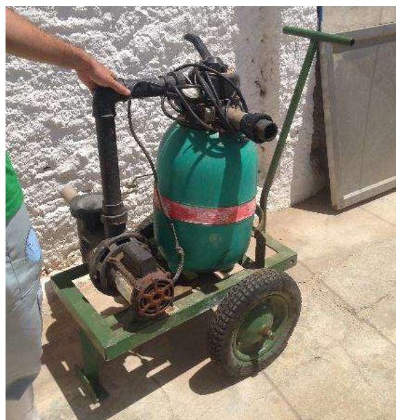
Figura III.3.1-3 – A) Bomba móvel para bombeamento de água e filtragem.
