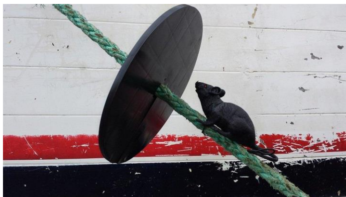
Figura 3. Modelo de barreiras para ratos que podem ser utilizadas em embarcações.
