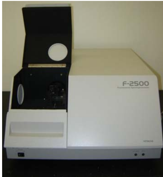
Figura 24 – Espectro - Fluorímetro HITACHI F-2500 para medição de fluorescência na água
