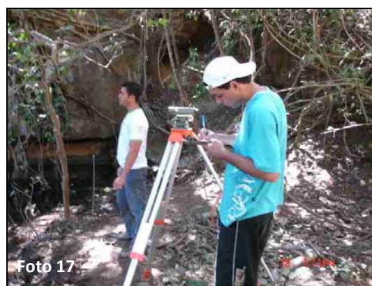
Fotos 16 e 17 – Poço do Surubim. Medição de vazão e nivelamento da base de referência
