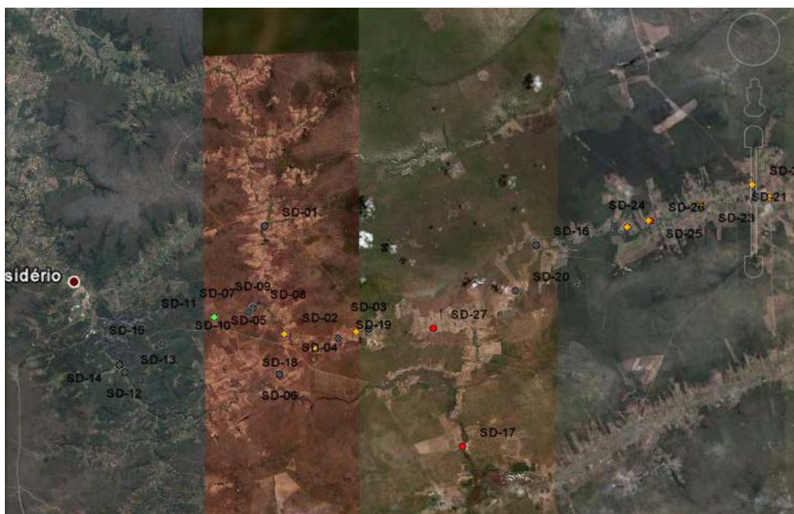
FIGURA 23 - Pontos visitados em campo. Vermelho: Pontos de injeção. Verde: Instalação de Fluorímetro. Cinza: Instalação de detectores passivos. Laranja: Outros pontos visitados como dolinas e sumidouros.
