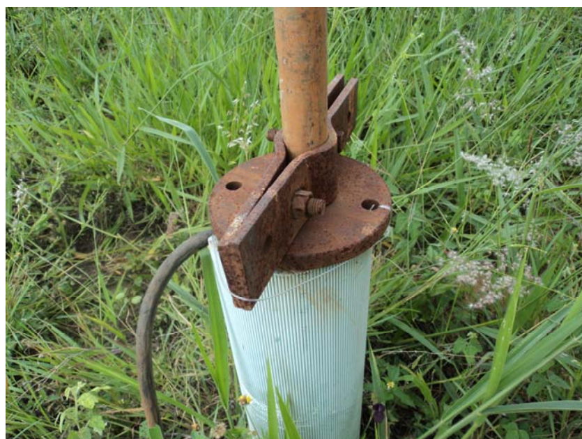
Foto 27 – Poço utilizado para a injeção da fluoresceína, situado a 10 km da nascente do SCRJR
