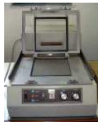
THERMOFORM: EQUIPAMENTO ESPECIAL PARA REPRODUÇÃO DE TEXTOS E FORMAS EM RELEVO.
