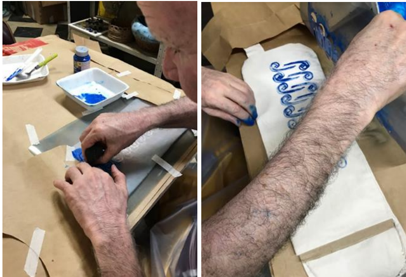
Figura 19: Realização da entintagem e retirada do estêncil sobre o protótipo da bolsa porta-bengala.
