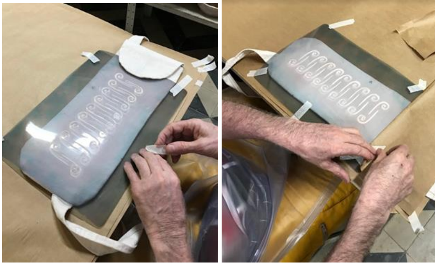
Figura 18: Fixação do estêncil sobre o protótipo da bolsa porta-bengala e cobertura das áreas do protótipo que ficaram expostas.
