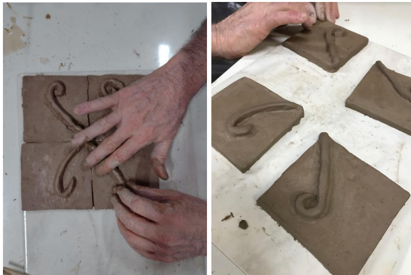
Figura 27: Colagem dos arabescos nas bases dos azulejos e o processo de acabamento.
