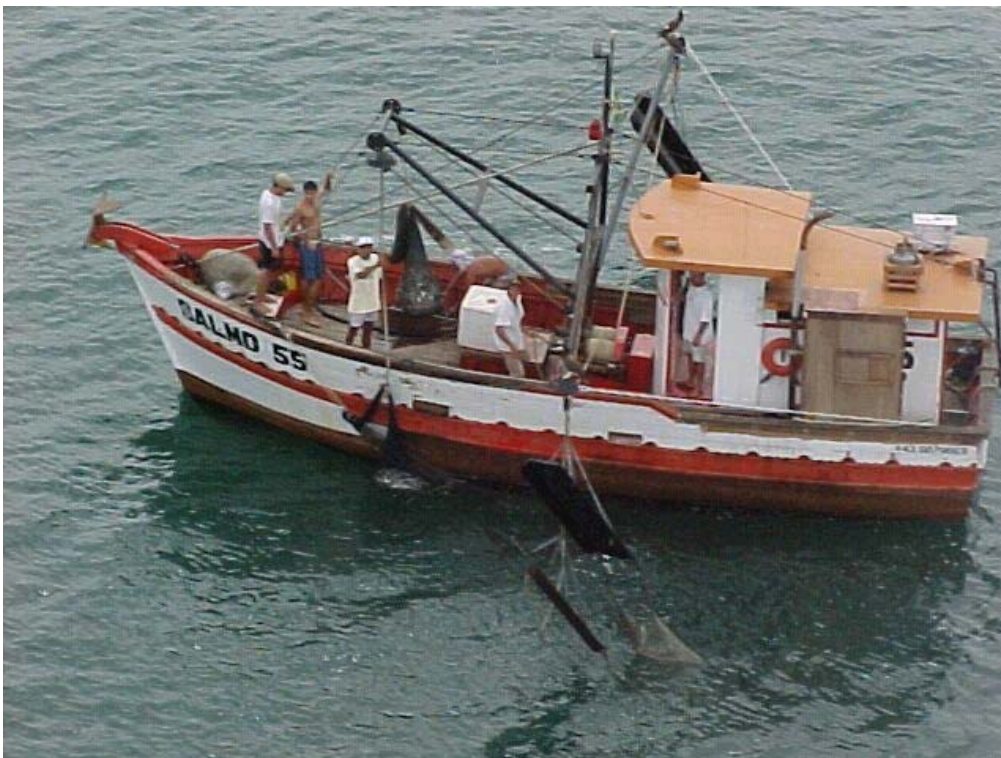
Barco pesqueiro de médio porte da frota paranaense, utilizado para captura de camarão, empregando o arrasto duplo com portas.
