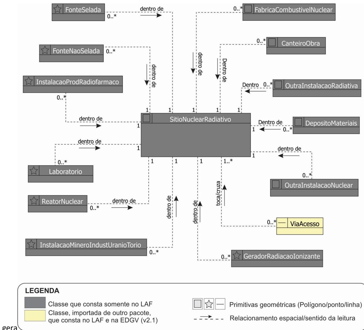
Figura 1 - - Modelo de dados referente ao tipo de projeto Instalações Nucleares/Radiativas.
