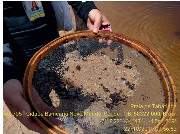
Foto 05: uso de peneira para separar areia de óleo, no litoral do estado da Paraíba.
