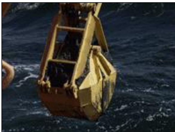
Foto 9: Uma pequena garra mecânica no fundo do mar, adequada para a coleta de óleo afundado.
