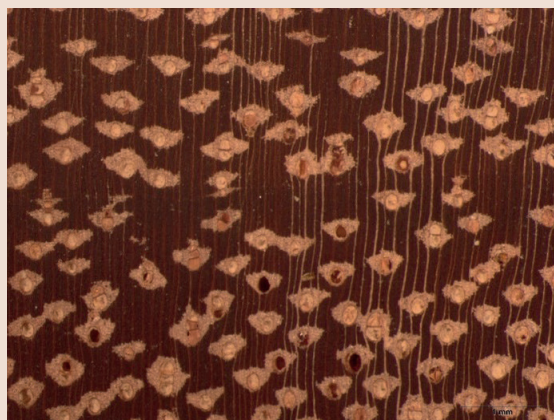
Figura 7. Dipteryx magnifica . Seção transversal da madeira. Fonte: Coradin et al. (2010).
