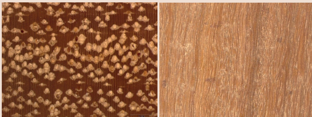
Figura 2. Dipteryx odorata . Seção transversal e seção longitudinal tangencial, respectivamente. Fonte: Coradin et al. (2010).
