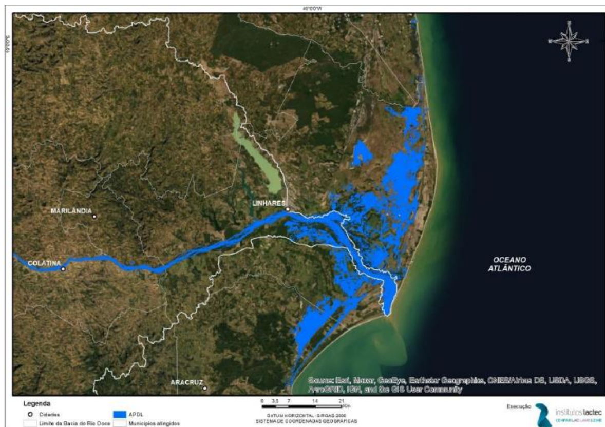
Figura 5 – Área de passagem e deposição da lama (ADPL) no município de Linhares obtida pela modelagem da cheia de janeiro de 2016 (Lactec, 2020c).
