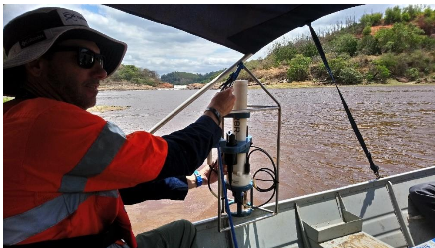
Imagem 1 – Utilização de uma sonda multiparâmetros XRX-620 em campo.
