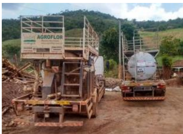
Figura 13: Caminhões de Hidrossemeadura
