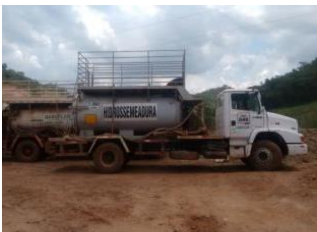
Figura 12: Caminhões de Hidrossemeadura
