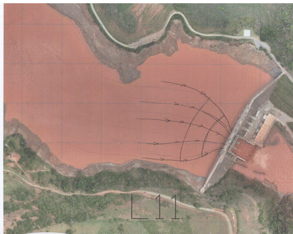
Figura 4 – Linhas de corrente na região do vertedouro.
