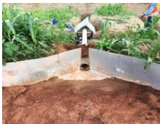
Figura 24: Detalhe do ponto de coleta de escoamento superficial na
