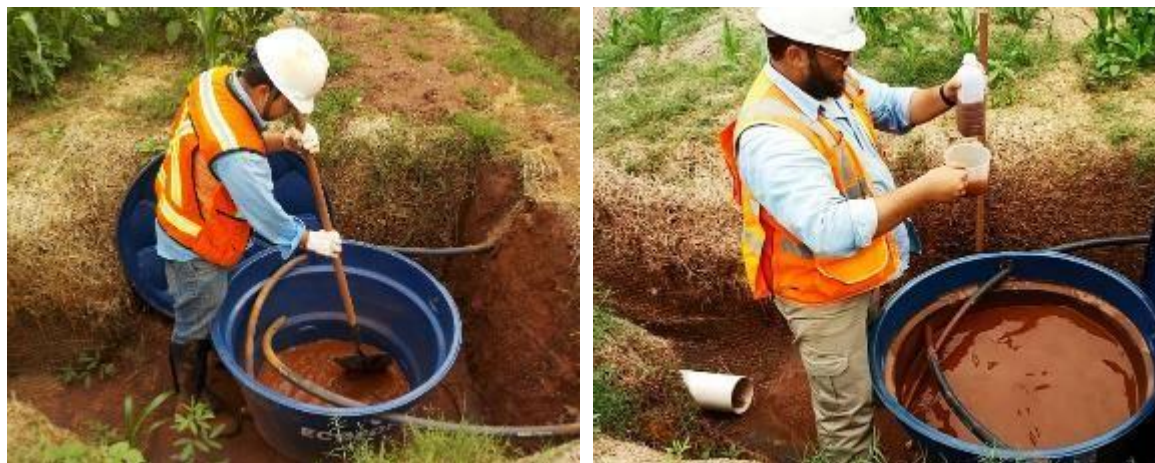
Figura 29: Processo de homogeneização e amostragem para determinação da concentração de sólidos no escoamento proveniente das parcelas de monitoramento de erosão.
