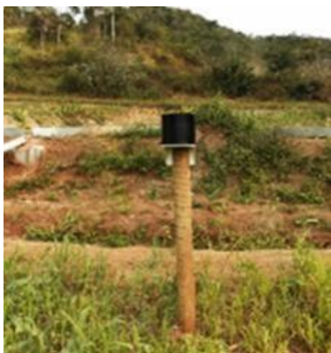
Figura 26: Data Logger das caçambas basculantes HOB0® Pendant® Event Data Logger (UA-003-64).
