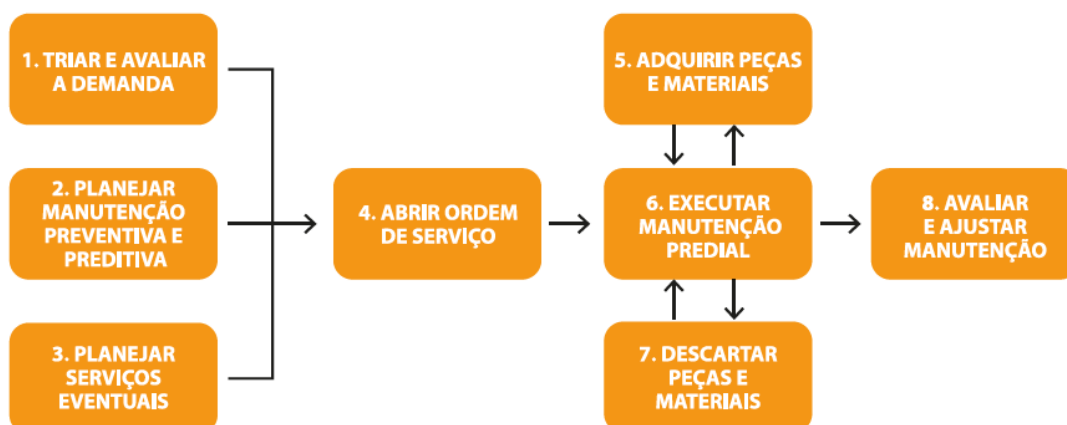
Figura 2: Fluxo base de manutenção predial (caderno EBSERH).
