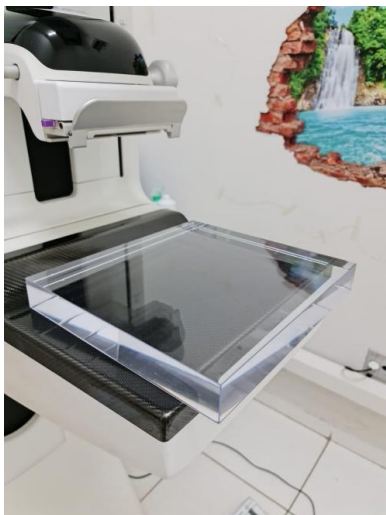
Figura 1 – Posição do phantom de acrílico sobre o detector do mamógrafo
