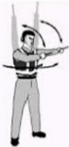
Figura 1. Ilustração de movimento de liberação da aproximação da equipe terrestre a helicóptero.
