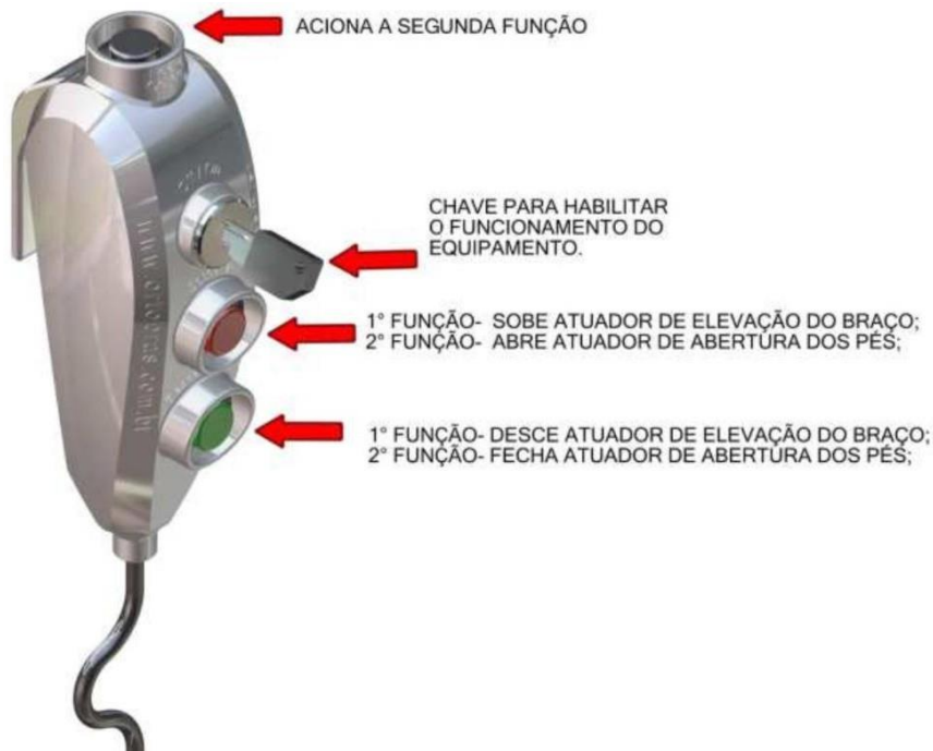
Figura 2 – descrição de acionamento
