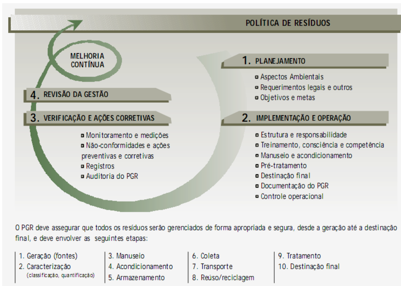
Figura 2. Sistema de Gerenciamento de Resíduos Sólidos.
