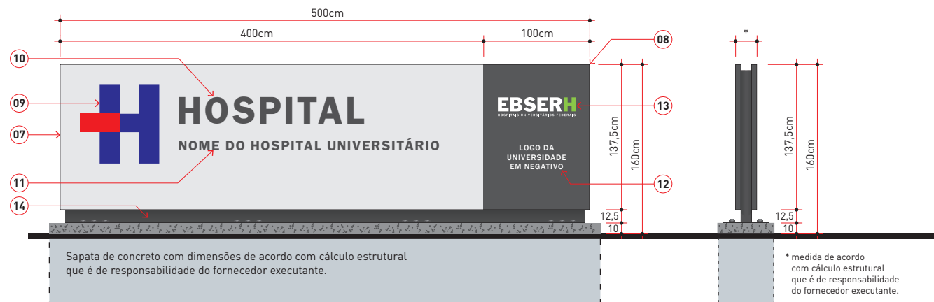
Vista Frontal Revestimento Escala 1:50
