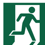
Saída de emergência (ABNT NBR 13434)
