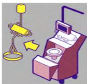
Figura 23 – Porta da centrífuga
