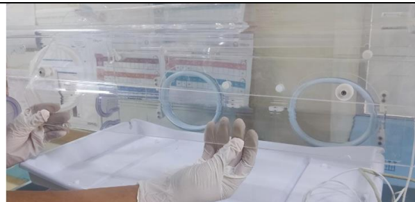
Imagem 11. Remover a parede dupla da cúpula
