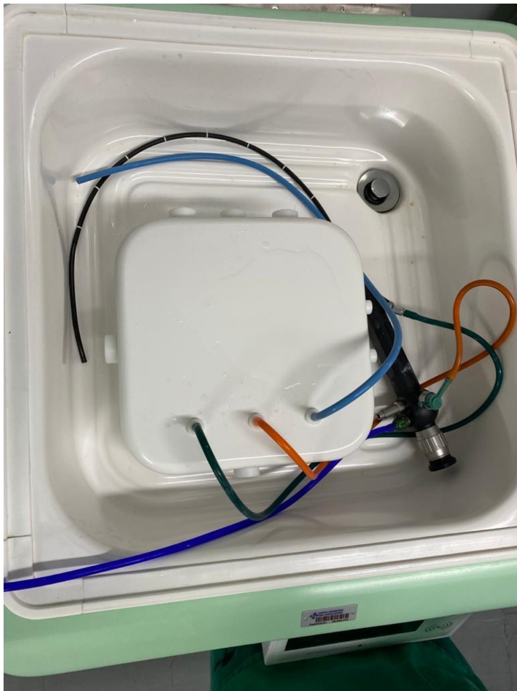
Acondicionamento correto na lavadora para início do ciclo automatizado
