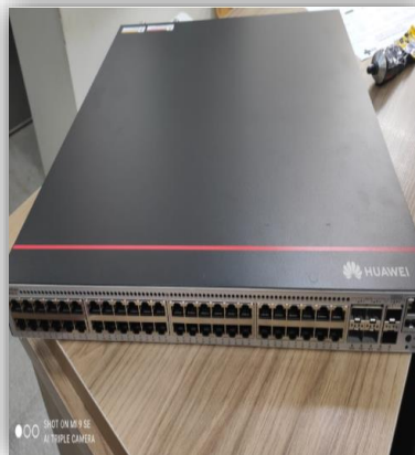
Figura 11. Switch de Rede
