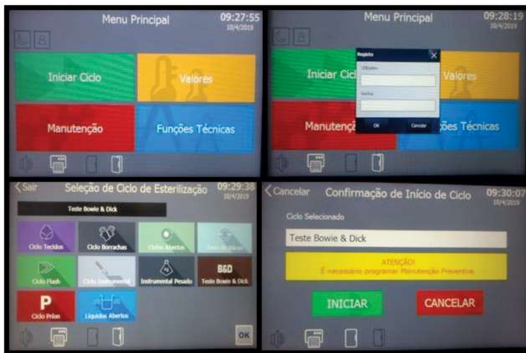
Figura 1 – Painel da autoclave e suas etapas de utilização
