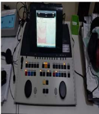
Figura 44. Audiometro digital Audiômetro, que avalia a capacidade de ouvir sons de um paciente. - 1 Unidade - Valor Total R$ 65.600,00
