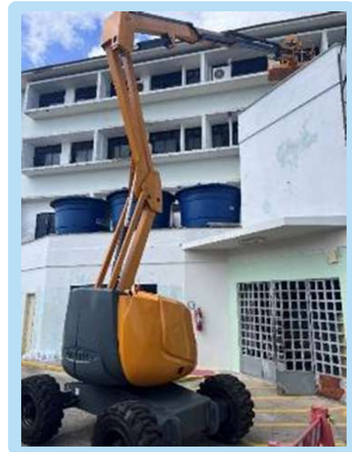
Figura 58: Plataforma Elevatória Articulada do HU-UFMA Fonte: HU-UFMA (2024)
