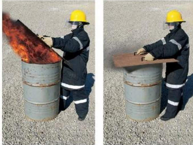
Fig. Exemplo de extinção por abafamento
