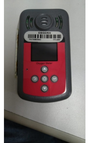
Figura 6. Equipamento medidor de gases medicinais
