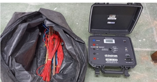
Figura 11. Equipamentos Terrômetro e Miliohmímetro
