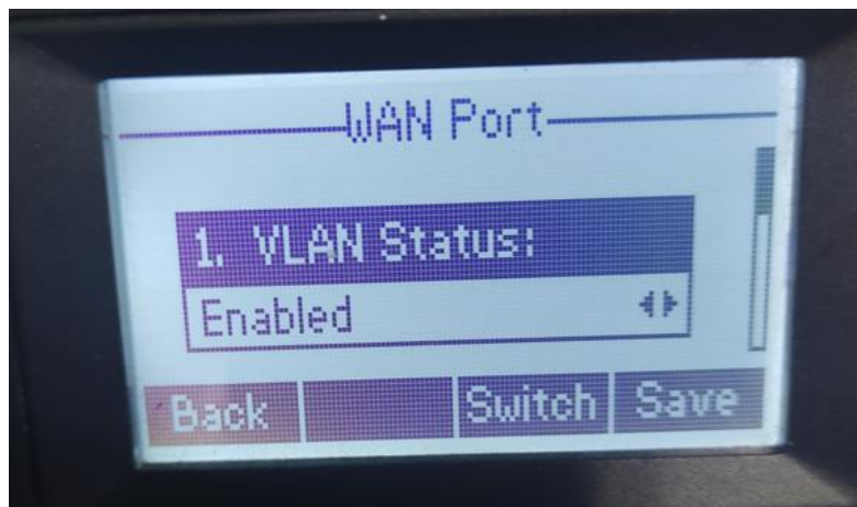
Figura 6 - Configurando "VLAN STATUS".
