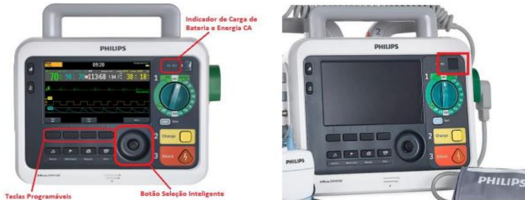
Figura 9 – desfibrilador MARCA PHILIPS MODELO EFFICIA DFM100
