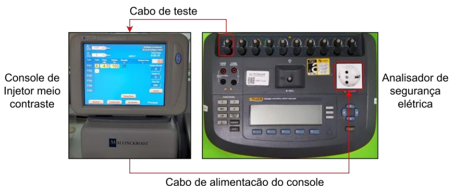
Figura 4 - Conexões para realização do teste de segurança elétrica.
