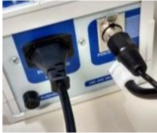
Figura 5 - Plugue de tensão e cabo de teste conectados ao analisador de segurança elétrica.
