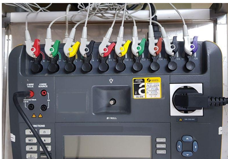
Figura 4 - Eletrodos de cabo de ECG de equipamentos do tipo eletrocardiógrafo conectados à analisador de segurança elétrica, superior; e cabo de teste de analisador de segurança elétrica conectado a carcaça de equipamento do tipo eletrocardiógrafo.
